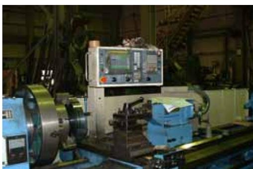
㈱ナカムラロールの長尺ロール軸加工機
