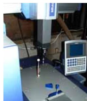
アントライオンの三次元自動計測装置
